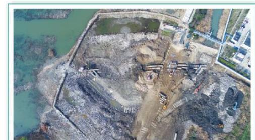
改造后，取水管道从环湖大堤底部穿过，利用水的自流原理取水，无需虹吸取水，取水连续性得到保障。
