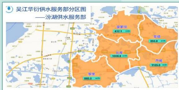
吴江砚南村是吴江华衍行政供水范围内的低压村之一,自来水供水压力的不足已对居民生产、生活造成一定影响,结合运行经验对低压情况进行分析,基本认定内部管线口径偏小、管网老化是造成低压及影响居民用水的因素。
