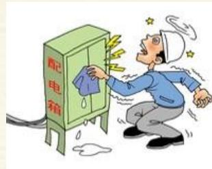
16、使用湿抹布擦拭配电箱、配电柜等带电电气设备。
