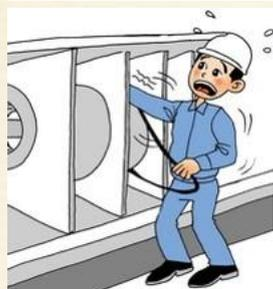
5、齿轮传动系统无防护罩，作业人员直接用手接触告诉运转的传动系统。
